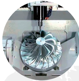
CNC中心加工機 最大加工能力 1000mm x 500mm
